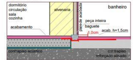
4.1 - assentamento do piso das áreas molháveis 4.2 - assentamento do piso sobre contrapiso acústico
