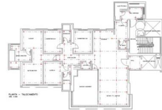
Figura 15: Planta de taliscamento.
