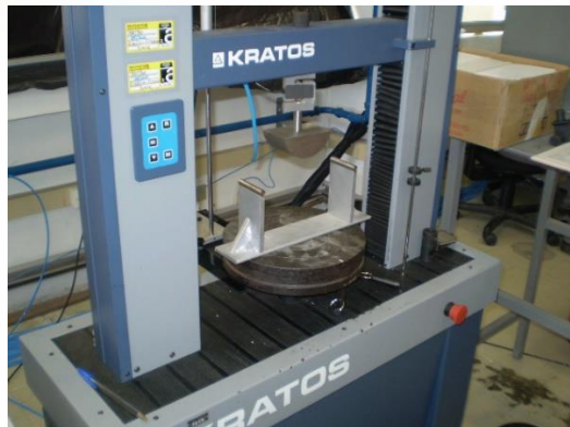
Figura 3 - Foto de ensaio de deformação transversal
